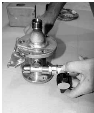
2. Insérer le joint en cuivre dans la bride de sortie et le placer sur la pièce centrale.
