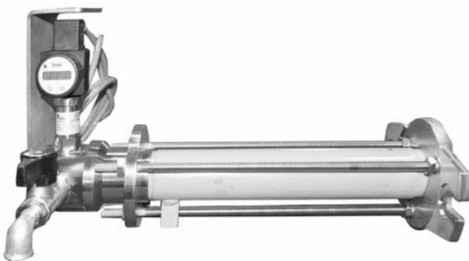
Die Druckregelung des Mörteldruckmanometers (Pumpen-Bausatz „HP“) ist werksseitig eingestellt und schaltet die Pumpe automatisch beim Erreichen von 90 bar ab bzw. bei Unterschreitung von 75 bar wieder ein).
