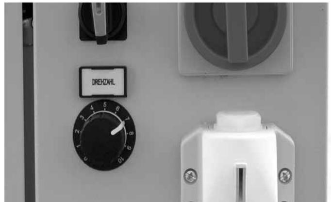
Die stufenlose Einstellung des Potentiometers (unten links) geht von 0 bis 10.
