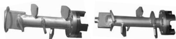
Die Pumpenwellen unterliegen dem Verschleiß. Wird die Minimalhöhe der Schneckenflügel erreicht oder unterschritten, muss die gesamte Pumpenwelle ausgetauscht werden.
