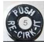
Bei zu hoher Belastung des Pumpenmotors wird der Überlastschutz ausgelöst.
