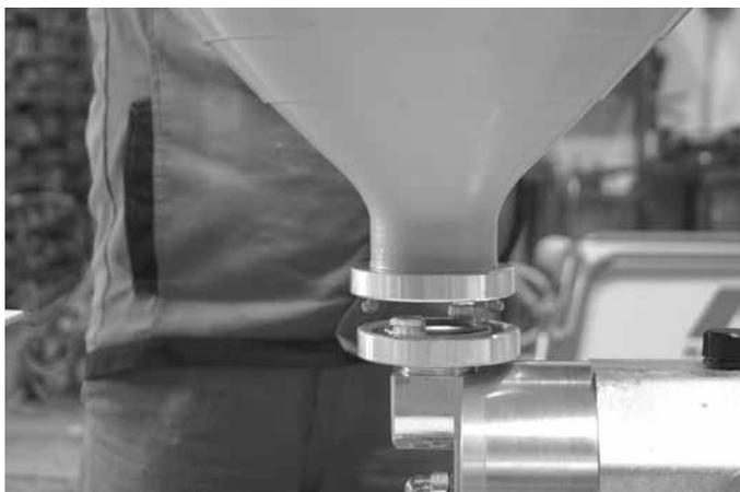
Der Materialbehälter wird mit einer Rechtsdrehung an den Grundkörper angeflanscht.
