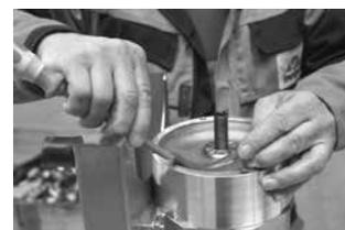
(4) Ziehen Sie die orange Membran durch vorsichtiges Hebeln mit einem Schraubenzieher heraus. Montieren Sie die neuen Teile in umgekehrter Reihenfolge.
