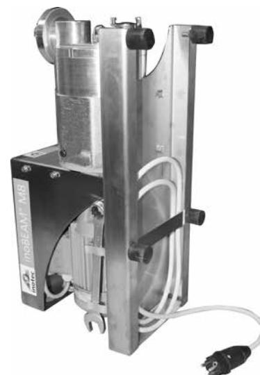
Das Stromkabel ist werksseitig unter der Förderpumpe versteckt. Die Maschine darf nur über eine Steckvorrichtung die durch ein RCD (FI)  $I_{\Delta n} \leq 30 \text{ mA}$  geschützt ist, betrieben werden.
