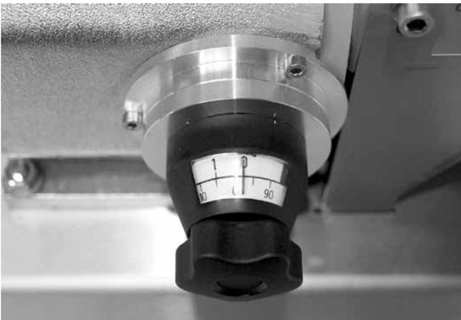
Der optimale Betriebsdruck und damit die Durchflussmenge ist stark materialabhängig. Mit dem Handrad können Sie den Druck stufenlos regulieren. Die Stellung 0 entspricht dem geringsten Druck. Der Maximaldruck entspricht dem Skalenwert ~ 4,5.
