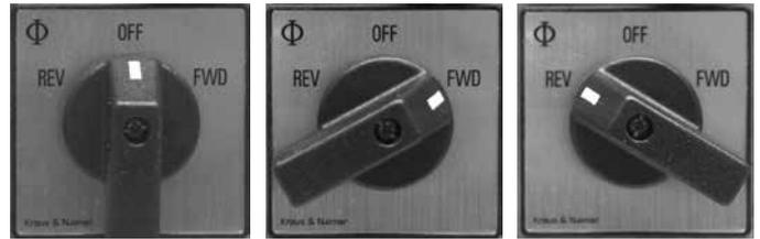
Steht der Hauptschalter auf „OFF“ ist die inoBEAM M8 ausgeschaltet. Zum Einschalten der Förderpumpe (Vorlauf) drehen Sie den Schalter nach rechts auf „FWD“. Die inoBEAM M8 ist mit einem Rücklauf ausgestattet den Sie mit der Einstellung „REV“ aktivieren können. Diesen Rücklauf benötigen Sie bei einem Schlauchstopfer. Durch den Rücklauf der Pumpe wird der Druck im Materialschlauch verringert.
