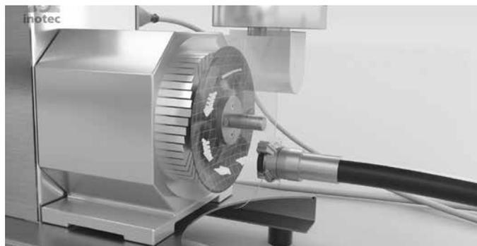
Das Material wird aus dem Materialbehälter angesaugt und durch Kontraktionsbewegungen weiter bis in den Materialschlauch gefördert.
