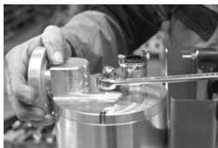
(1) Lösen Sie die Hutmutter (M16) an der Vorderseite der Förderpumpe. Benutzen Sie dazu den 24er Gabel-Ringschlüssel, der am Grundkörper befestigt ist.
