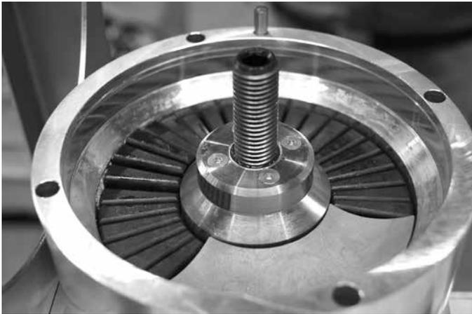
Blick auf die Schieberplatten im Pumpengehäuse nach der Entfernung der grünen Förderscheibe und der orangefarbenen Membran.
