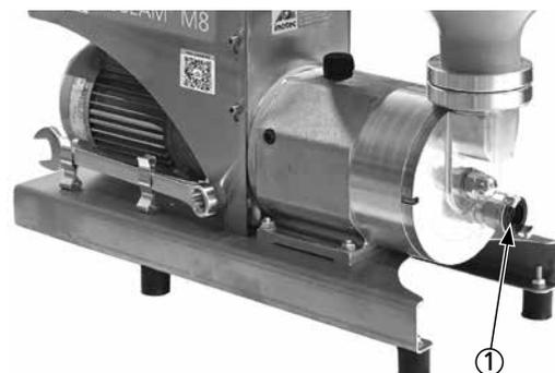
GEKA-Kupplung (1) unterhalb des Materialbehälters zum anflanschen des Materialschlauches.
