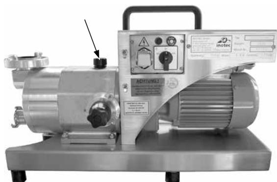
Das Getriebe ist mit Fließfett Panolin LT Grease 00 gefüllt und auf eine Lebensdauerschmierung ausgelegt. Ein Austausch dieses Fetts ist nicht erforderlich.
