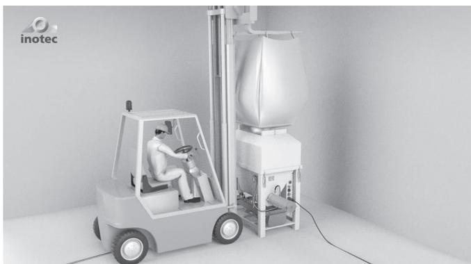
Materialbestückung des Kleinsilos mit Big-Bags über die Aufsatzhaube (kaum Staubentwicklung); Raumhöhe mind. 500 cm.
