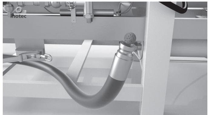
8. Füllen Sie noch einmal etwas Wasser in den Pumpentrichter und starten Sie die Maschine durch Drücken des Doppeldrucktasters „Pumpe Reset“ „1“. In diesem Reinigungsdurchlauf wird der Pumpentrichter, die Pumpenwelle sowie die Pumpeneinheit (Rotor/Stator) gereinigt. Die Schwammkugel wird dabei zusammen mit dem Wasser durch den Materialschlauch gefördert und löst eventuell anhaftendes Restmaterial von den Wänden des Mörtelschlauches.
