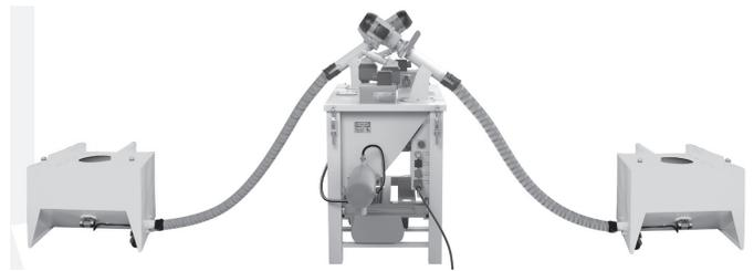
Chargement du matériel du petit silo avec des grands sacs via deux boîtes à grands sacs et l'unité de convoyage à sec inoFLEX Duo (peu de poussière) ; hauteur de la pièce min. 180 cm.
