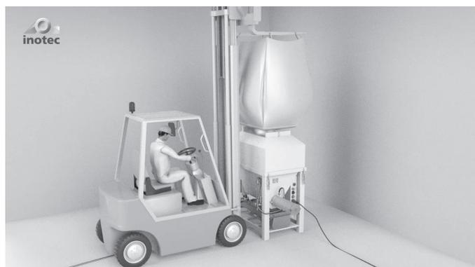
Chargement du matériel du petit silo avec des grands sacs par le capot de fixation (presque pas de formation de poussière) ; hauteur de la pièce min. 500 cm.
