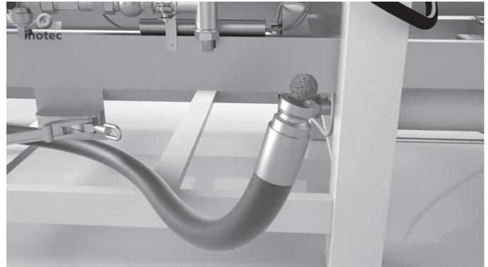
8. Remplissez un peu plus d'eau dans la trémie de la pompe et démarrez la machine en appuyant sur le double bouton poussoir "Pump Reset" "1". Au cours de ce cycle de nettoyage, la trémie de la pompe, l'arbre de la pompe et l'unité de pompage (rotor/stator) sont nettoyés. La balle éponge est transportée avec l'eau dans le tuyau de matériau et détache les résidus de matériau qui ont pu adhérer aux parois du tuyau de mortier.
