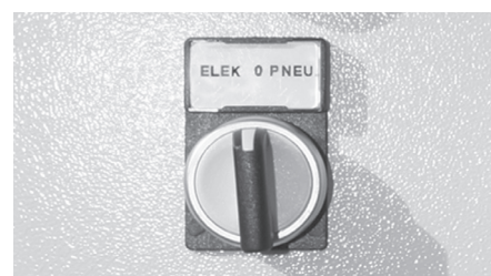
Schalter für die elektrische oder pneumatische Steuerung der Maschine.
