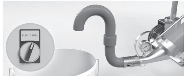
3. Appuyez sur le bouton "Arrivée d'eau" et remplissez la partie inférieure de la zone de mélange jaune avec un peu d'eau (jet d'eau !) puis relâchez le bouton.
