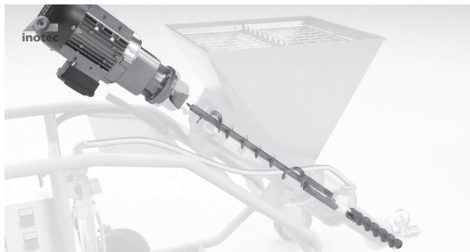
Cette image en coupe montre la connexion du moteur à l'hélice de mélange et de cette dernière à l'unité de pompage (rotor/stator).
