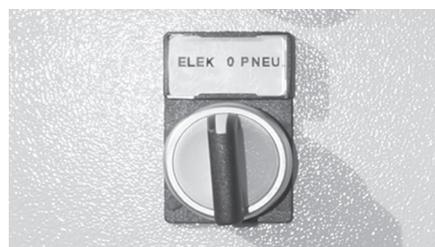
Interrupteur pour la commande électrique ou pneumatique de la machine.
