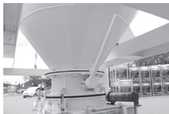
Rechts: Hebel zum Öffnen der Siloauslaufklappe
