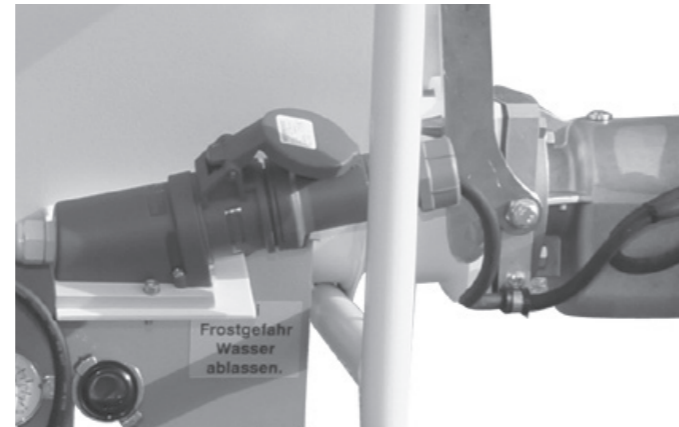
CEE-Stecker des Motors in der Steckdose
