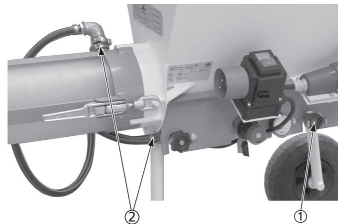
Anschluss der externen Wasserversorgung (1), Anschluss des Mischrohrs an die Wasserversorgung (2).
