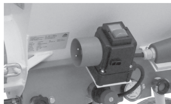
Branchement du courant alternatif (230 V).
