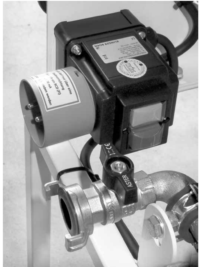
Anschluss Wechselstrom (230 V) und externer Wasseranschluss zum Reinigen der Maschine.
