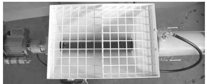
Materialbehälter mit Trichtergitter und Zahnleiste
