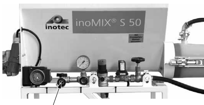
Links an der Wasserarmatur befindet sich ein GEKA-Anschluss für einen Wasserschlauch für die Reinigung des Mischrohrs und der Mischwelle.
