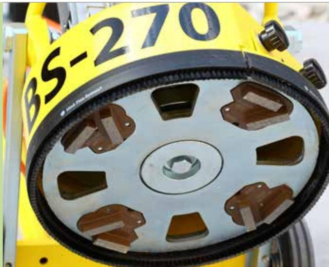
Die **BS-270-EL-9** ist eine leicht zu transportierende Maschine für den vielseitigen und schlagkräftigen Einsatz in der Untergrundvorbereitung. Sie ist perfekt geeignet für kleinere bis mittlere Flächen. Dank einem abnehmbaren Seitendeckel hat diese Bodenschleifmaschine eine hervorragende Randgängigkeit. Durch ihre kompakte Bauweise ist sie gut im Fahrzeug zu verstauen.
