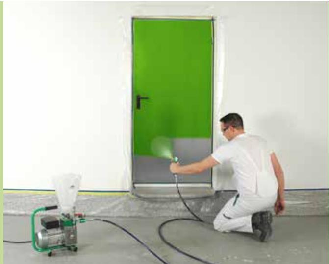
Die **inoSPRAY A 4000** ist ein universell einsetzbares Membran-Airlessgerät zum Spritzen von Dispersionen auf kleineren Flächen, zum Lackieren und Verpressen.
