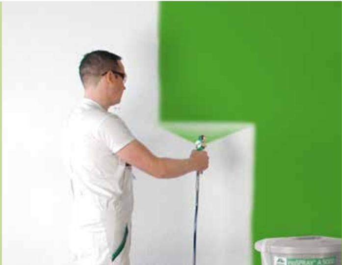
Die **inoSPRAY A 5000** ist ein leistungsfähiges Membran-Airlessgerät mit mittlerer Förderleistung. Sie ist für kleinere und mittelgroße Objekte geeignet.
