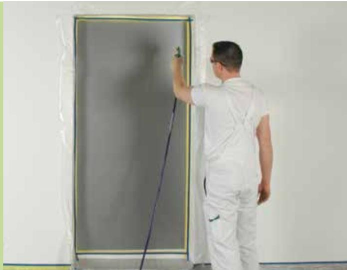
Die **inoSPRAY MP2** ist ein universell einsetzbares 230 V Airless-Spritzgerät zum Spritzen von Dispersionen auf kleineren Flächen bis Düsengröße 0,021".
