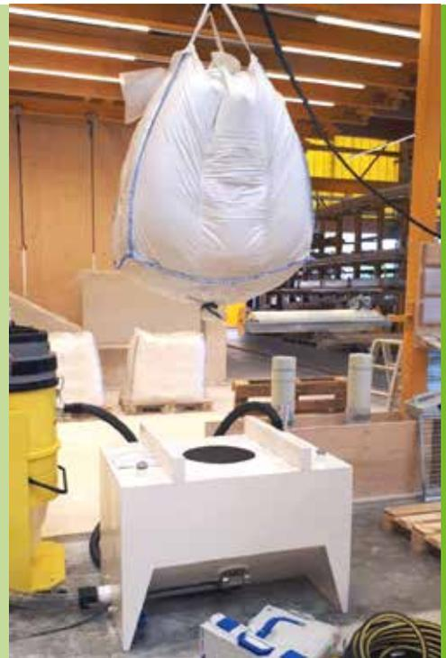
La conexión con la unidad flexible de transporte en seco **inoFLEX Mono** garantiza un suministro continuo de material en el contenedor de material de la bomba mezcladora (inoCOMB Picco Power o Maxi Power).
