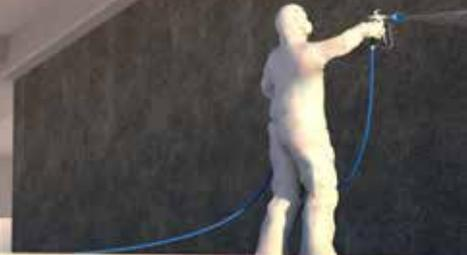
Dispositivos airless para pulverizar con eficiencia pintura, barniz, dispersiones o rellenos en interiores y exteriores.
