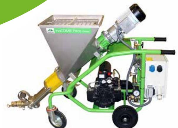
\* con mezcladora continuo integrada de 400 V y bomba de alimentación de 400 V
