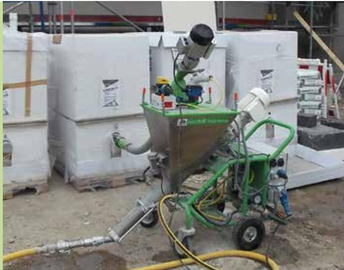
El eje de transporte flexible **inoFLEX Mono** transporta el material a procesar desde el contenedor de un solo uso directamente al contenedor de la bomba mezcladora y desde allí en la manguera de material a la pistola rociadora o de pegamento.
