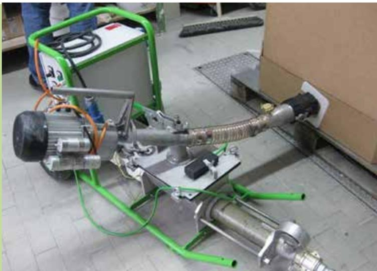
El eje de alimentación flexible del **inoFLEX Mono pastoso** transporta el material a procesar desde un contenedor de un solo uso o desde un contenedor IBC directamente al contenedor de la bomba de alimentación y desde allí a través de la manguera de material a la pistola de pulverización o de pegamento. La unidad de transporte en húmedo **inoFLEX Mono pastoso** se combina con la bomba de alimentación **inoBEAM F30 E**.
