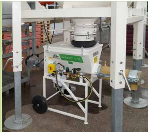
L'**inoMIX S50 S** est un mélangeur continu de 400 V puissant d'une qualité supérieure. Son moteur puissant permet de traiter toutes les matières poudreuses courantes rapidement et en toute simplicité. Il est maniable, puissant et se monte et se démonte en quelques gestes. L'alimentation en matière peut se faire au moyen de sacs ou, en combinaison avec le capot de transfert, directement à partir d'un silo.
