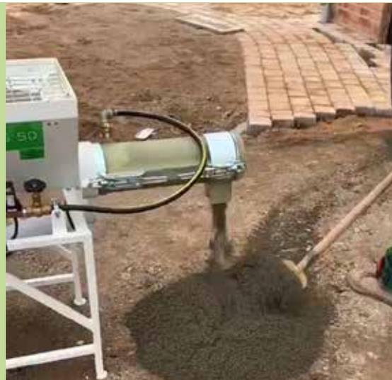
L'inoMIX S50 est un mélangeur continu de 230 V puissant d'une qualité supérieure. Son moteur puissant permet de traiter toutes les matières poudreuses courantes rapidement et en toute simplicité. Il est maniable, puissant, se monte et se démonte en quelques gestes seulement.
