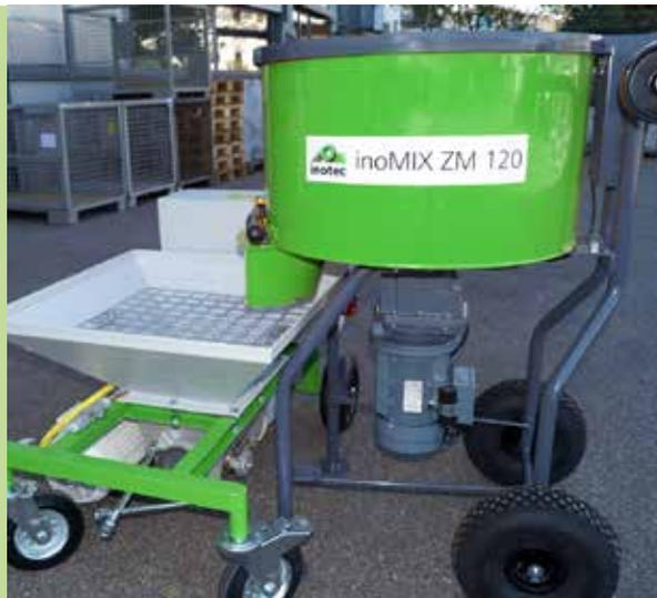
L'**inoMIX ZM120** est un mélangeur à action forcée robuste et sans entretien pour le mélange efficace et homogène de diverses matières. La technique de mélange à 3 bras assure un mélange intense et homogène de la matière. Ce mélangeur est solide et compact, équipé de roues pour le transport, parfait pour les travaux difficiles sur un chantier.
