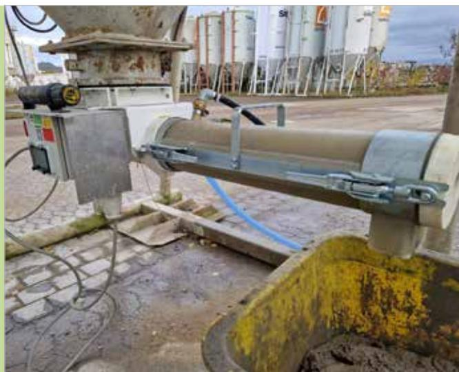
L'**inoMIX F52** est un mélangeur continu de 400 V parfait pour l'utilisation en silos pour mélanger des matières pulvérulentes. Grâce à sa conception compacte, l'**inoMIX F52** peut rester bridé sur le silo pendant le transport.
