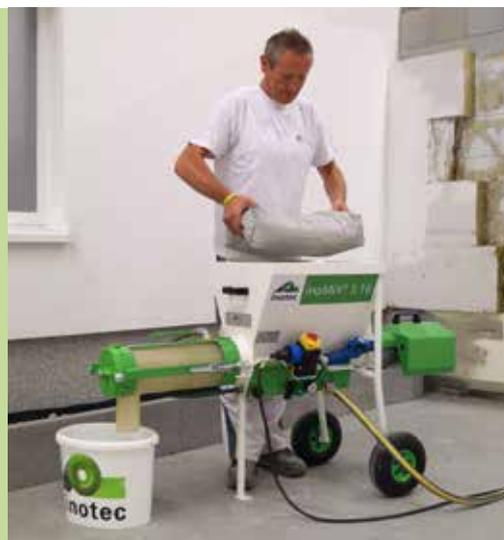
La simplicité de manipulation du mélangeur continu **inoMIX S16** révolutionne le malaxage des matières pulvérulentes. Il est maniable, puissant et se monte et se démonte en quelques gestes seulement. Par ailleurs, l'**inoMIX S16** convient également à des matières complexes telles que les chapes en béton à consistance de terre humide.
