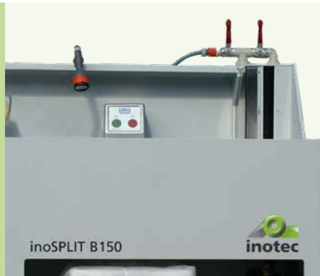
Die **inoSPLIT B150** dient zur Reinigung von Maler- und Stuckateurwerkzeugen und zur entsorgungsgerechten Aufbereitung von Schmutzwasser.
