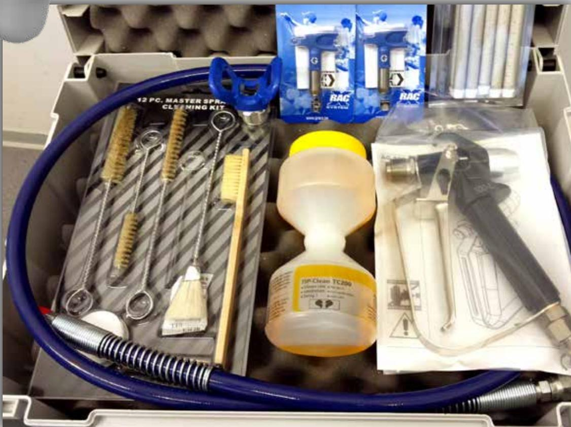
**Équipement de la mallette de secours** : Pistolet Airless AG500-L-G, 10 x filtre emboîtable blanc, support de buses RAC X, buse réversible RAC X 517, buse réversible RAC X 521, tube flexible ¼", TipClean, kit de nettoyage avec brosses
