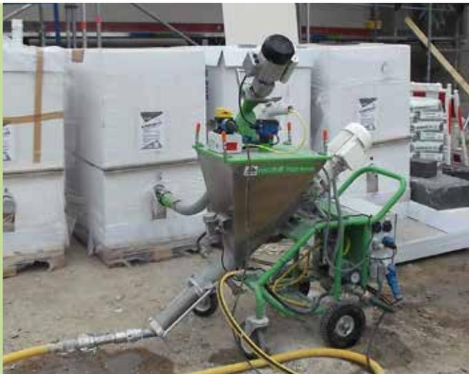
L'arbre d'alimentation flexible **inoFLEX Mono** transporte la matière à traiter du One-Way-Container directement au récipient de la pompe mélangeuse et de là, dans le tuyau de matière pour le pistolet de pulvérisation ou le pistolet à colle.
