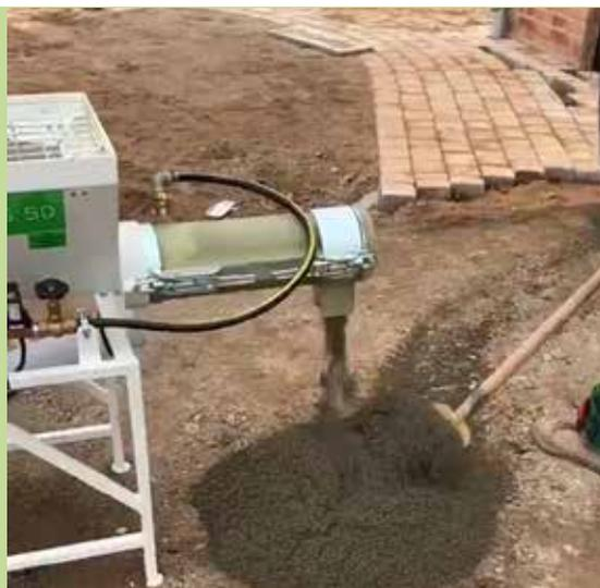
L'**inoMIX S50** est un mélangeur continu de 230 V puissant d'une qualité supérieure. Son moteur puissant permet de traiter toutes les matières poudreuses courantes rapidement et en toute simplicité. Il est maniable, puissant, se monte et se démonte en quelques gestes seulement.
