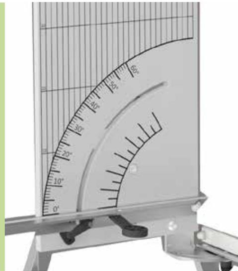
Das handliche und leichte Heißdraht-Schneidegerät **inoCUT ic127** ist ein praktisches und präzises Spitzengerät. Es wird als Standgerät eingesetzt. Mit der integrierten Kipp-sicherung kann das Gerät auch an der Geländerstange befestigt werden. Die schwenkbare Dämmplattenstütze hält auch dicke Dämmplatten kipp-sicher im Gerät.
