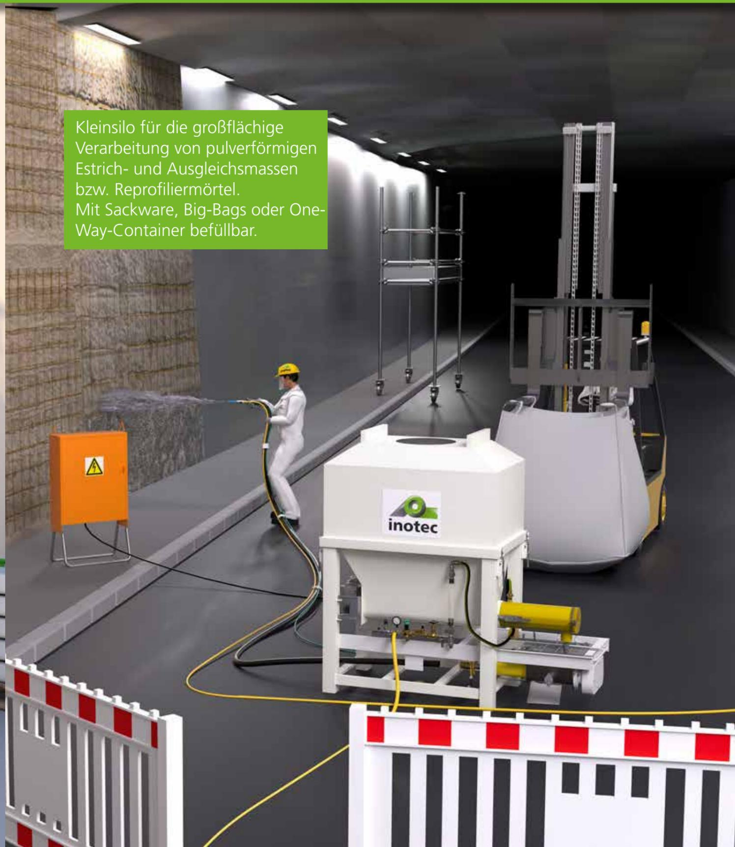
Kleinsilo für die großflächige Verarbeitung von pulverförmigen Estrich- und Ausgleichsmassen bzw. Reprofiliermörtel. Mit Sackware, Big-Bags oder One-Way-Container befüllbar.
